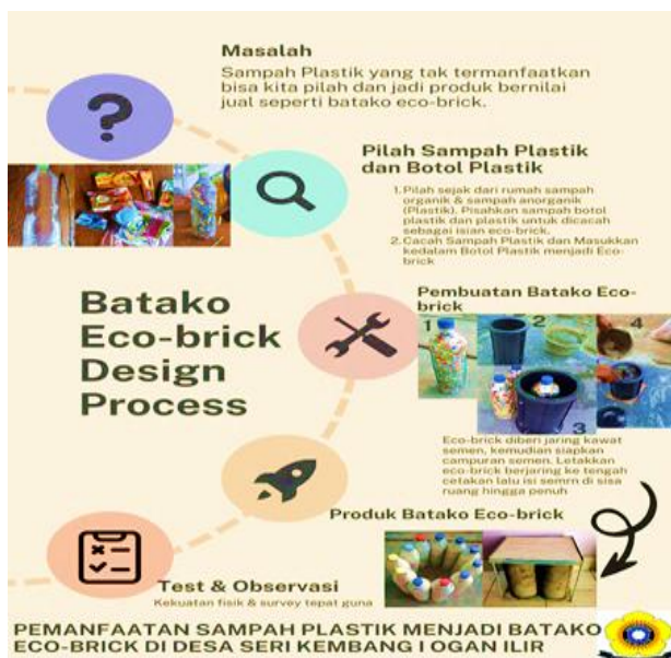
Gambar 3. Prosedur Pembuatan Batako Eco-brick
