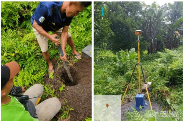
Gambar 5. Pemasangan dan Pengukuran Titik Acuan BM dan CP
