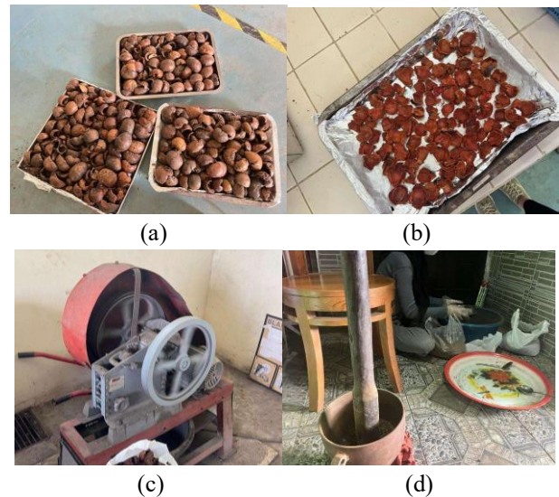
Gambar 3. (a) Kulit Manggis Sebelum Preparasi, (b) Kulit Manggis Setelah di Keringkan, (c) Pemecahan Kulit Manggis dengan Jaw Crusher , (d) Pemecahan Kulit Manggis Menggunakan Alu
