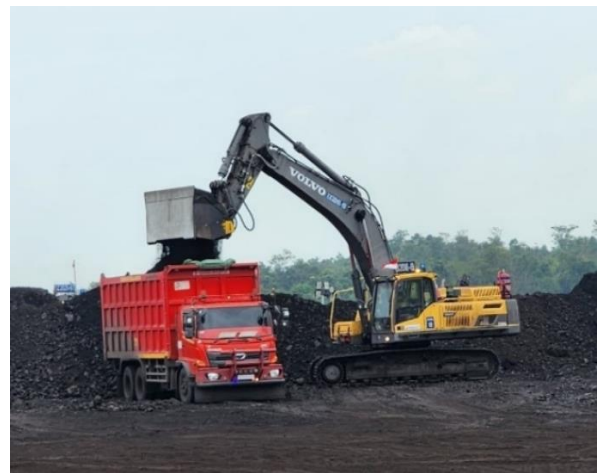
Gambar 3. Proses kerja bucket crusher pada excavator
