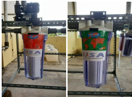
Gambar 3.1. Filter cartridge dengan diameter pori 3 \mu\text{m} , diikuti dengan filter spon berdiameter pori 1 \mu\text{m} .
