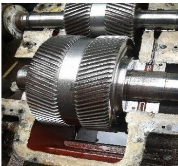
Gambar 6. Saat akan melakukan pengukuran backlash
