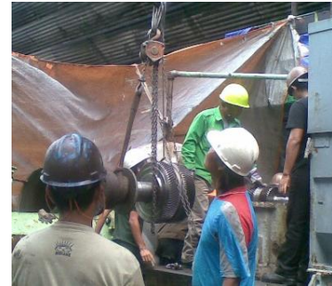
Gambar 7. Pengangkatan high speed gear
