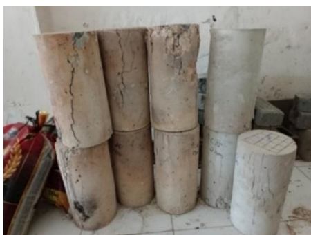
Gambar 5. Benda uji silinder kuat tekan beton
