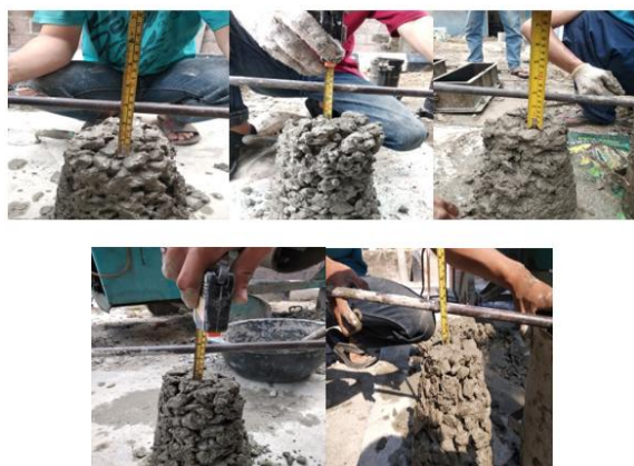
Gambar 3. Hasil slump test beton normal dan bakar
