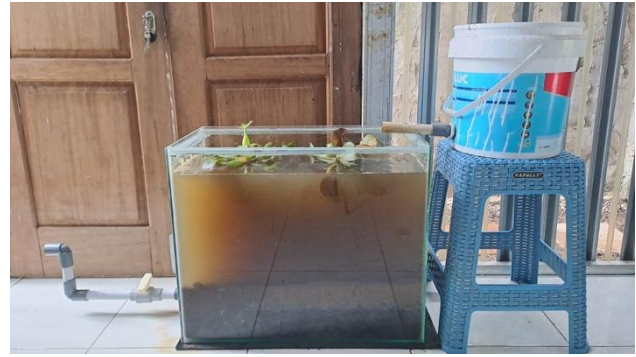
Gambar 2. Sistem lahan basah buatan tipe FWS skala laboratorium.
