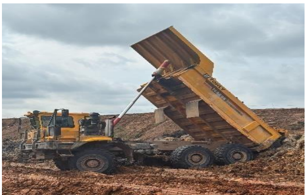
Gambar 5. Kegiatan penimbunan overburden di disposal barat
