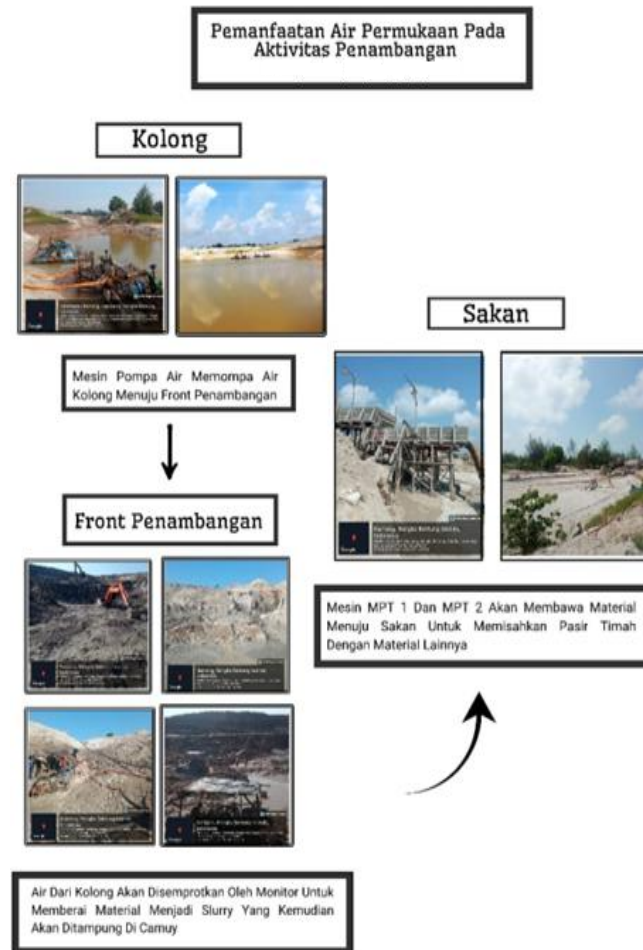
Gambar 2. Bagan Alir Pemanfaatan Air Permukaan Pada Aktivitas Penambangan Timah Alluvial
