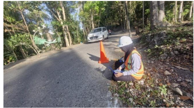
Gambar 6. Pengambilan data getaran menggunakan Micromate InstanTel
