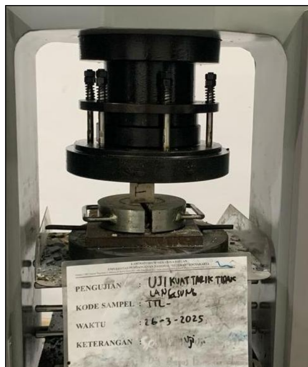
Gambar 2. Contoh Proses Uji Laboratorium Sifat Mekanik Sampel Batuan pada Terowongan Watu Jonggol
