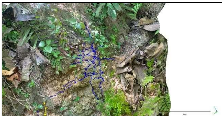
Gambar 9. Tracing Tool pada Plugin Compass CloudCompare
