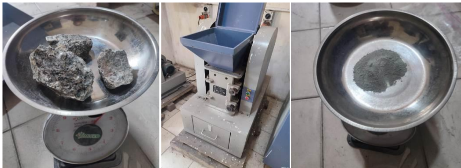
Gambar 4. Proses Penghalusan Sampel XRF (Kiri: Bongkah Batuan, Tengah: Crusher , Kanan: Sampel Uji)
